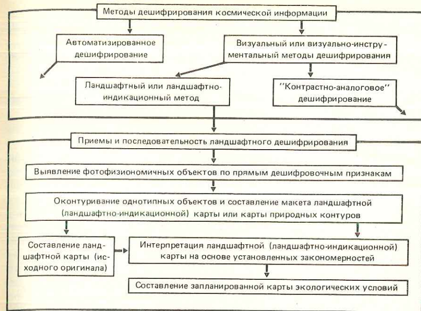
Рис. 6. Блок-схема дешифрирования космических снимков при составлении экологических карт
